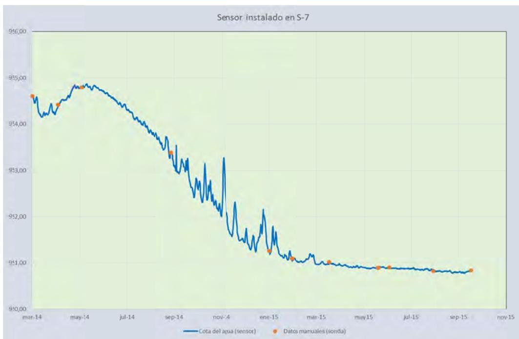
Figura 6.5: Evolución piezométrica en S-7 (data logger).
